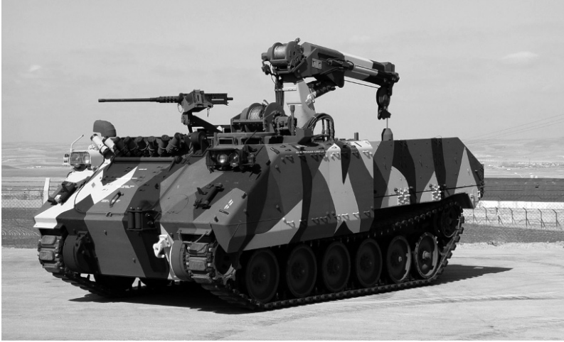
Fotoğraf 21: FNSS'in ürettiği AKINCI Zırhlı Muharebe Aracı (AKINCI ZMA). [Erişim Tarihi: 08.01.2020]. https://www.fnss.com.tr/urun/akinci-zma#next .
